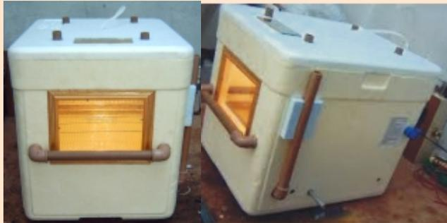
Figura 1: Parte frontal e lateral da Incubadora de ovos
