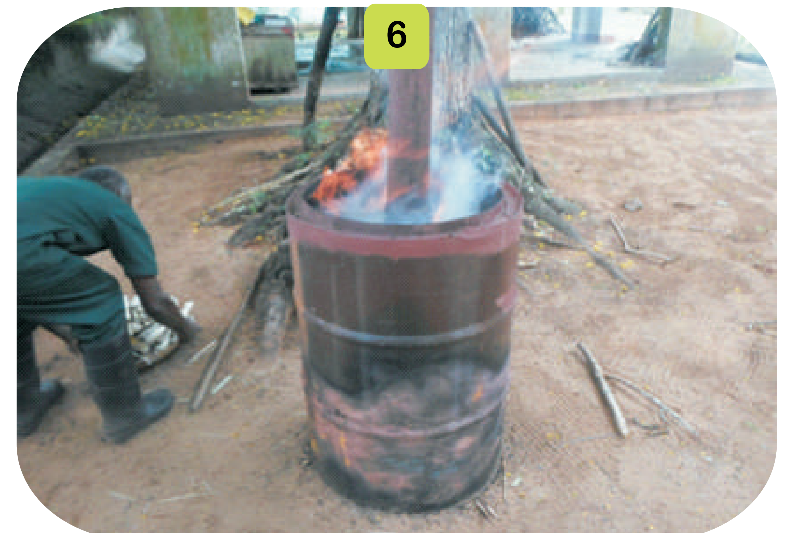
A deposição de pedaços no forno prossegue. Geralmente, deposita-se 10 kg de material de cada vez até encher o tambor, enquanto decorre o processo de carbonização
