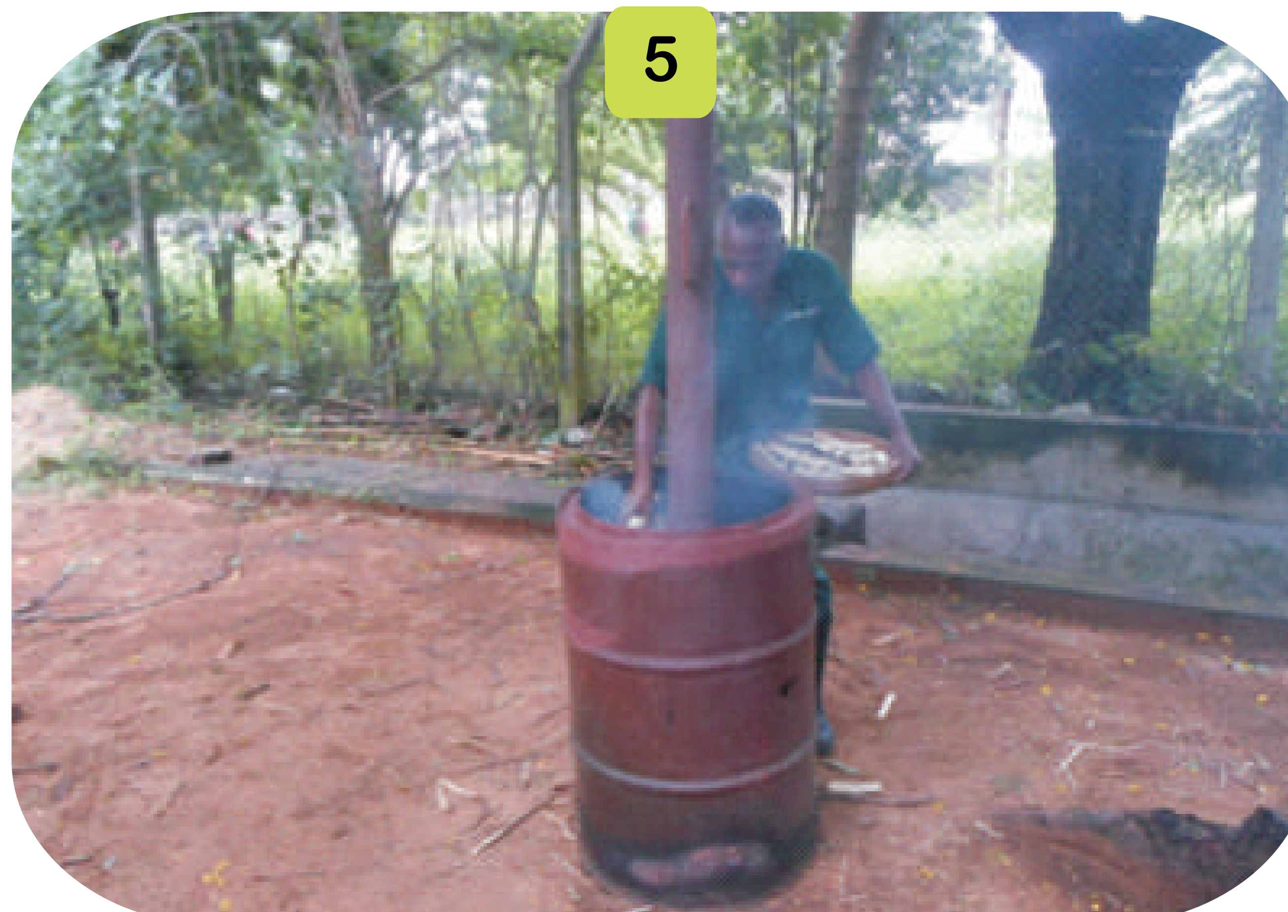
Após a ignição do forno, começa o processo de deposição gradual de pedaços de bambu no forno.
