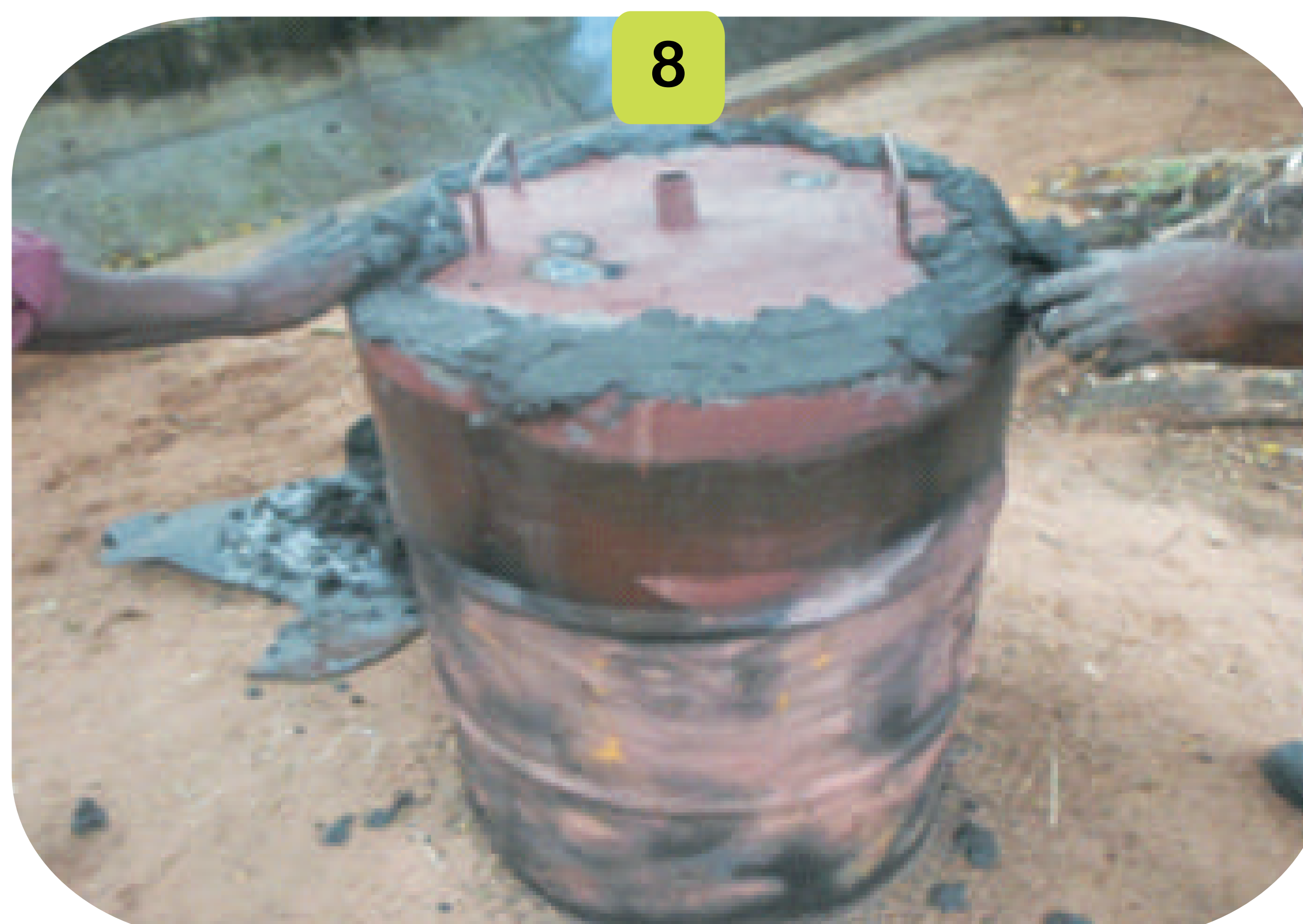
A tampa do forno é selada com argila para evitar a entrada de ar livre, permanecendo assim, pelo menos por 4 h a 6 h de tempo. O forno deve ser vigiado.
