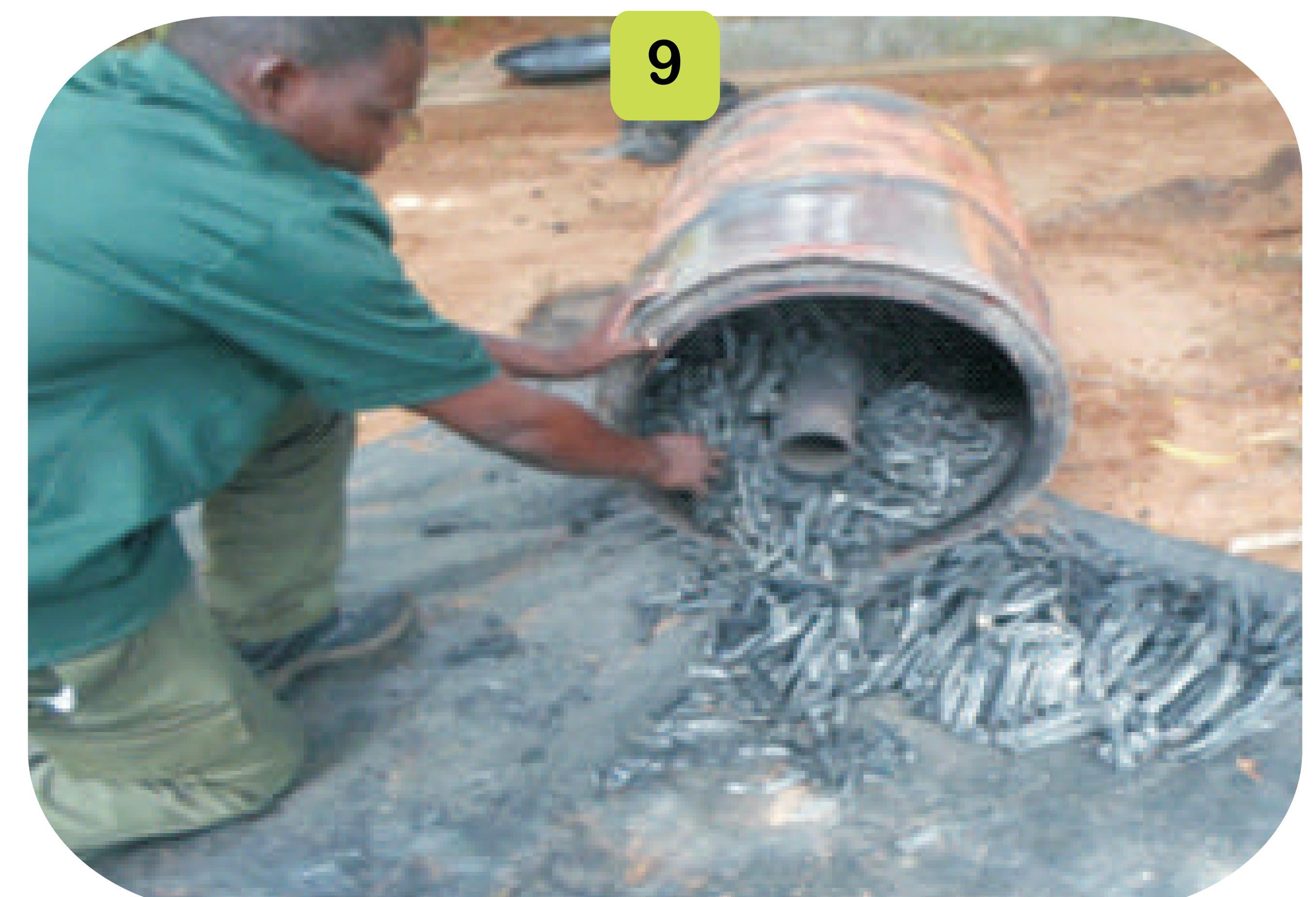
Após o arrefecimento do forno, e retirada a tampa e procede-se com a recolha do carvão vegetal formado
