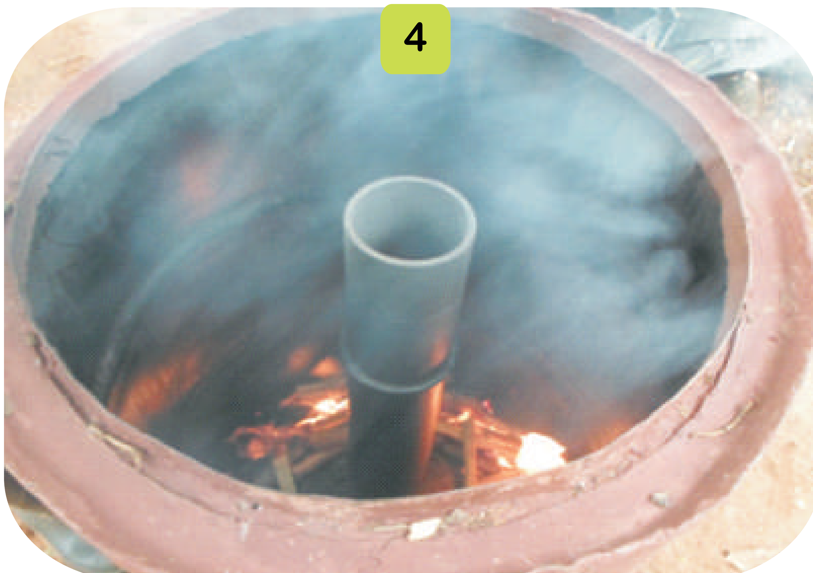
Após a secagem dos pedaços de bambu por mais ou menos 2 semanas, procede-se com a ignição do forno.
