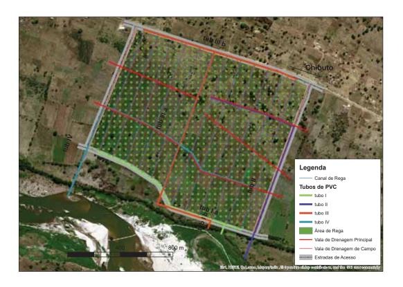
Figura 2: Esquema Geral do Regadio 7 de Abril (tubos e canais de rega, valas de drenagem, estradas e vias de acesso).
