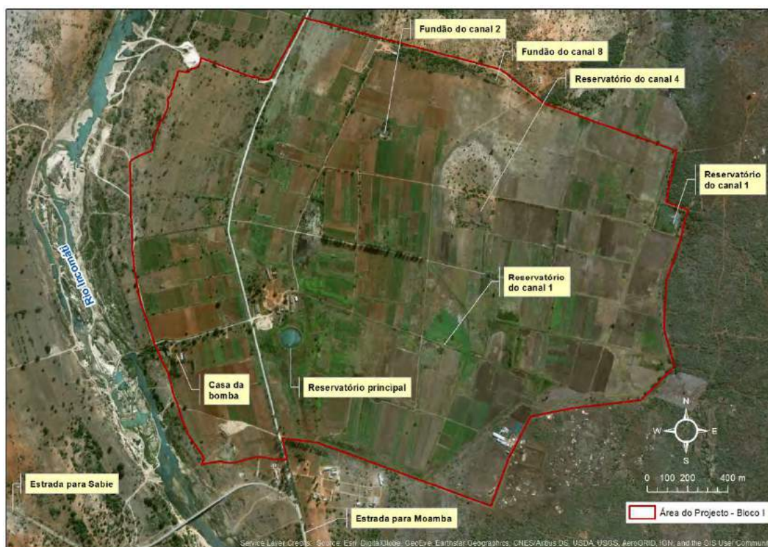
Figura 2: Configuração do Bloco I do Regadio da Moamba
